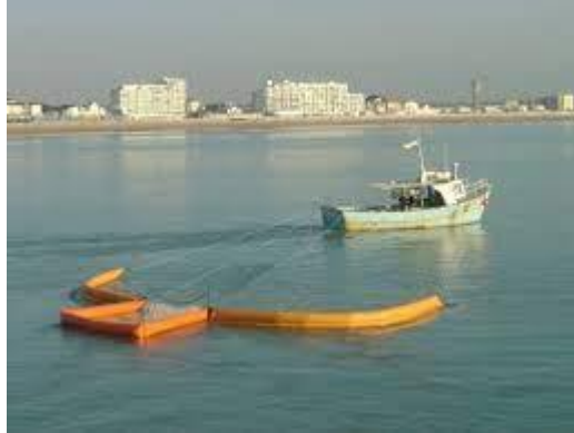
Figure 16 : Chalut développé par Thomsea
